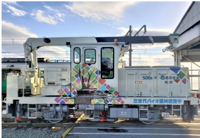
RD を使用して運行するラッピングされた保線機械（モーターカー）
