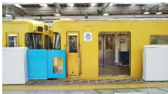
写真② 4ドア車両（例：2000系 8+2両編成）が停車した場合のホームドア開扉の様子
