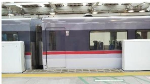
写真① 10000系車両が停車した場合のホームドア開扉の様子
