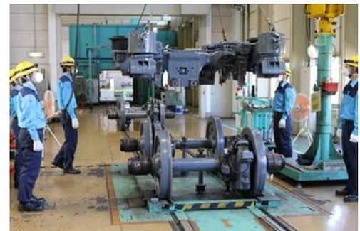
車輪に台車を被せる作業
