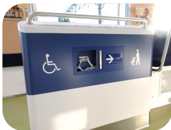
<車いすやベビーカーを固定する設備を搭載>
