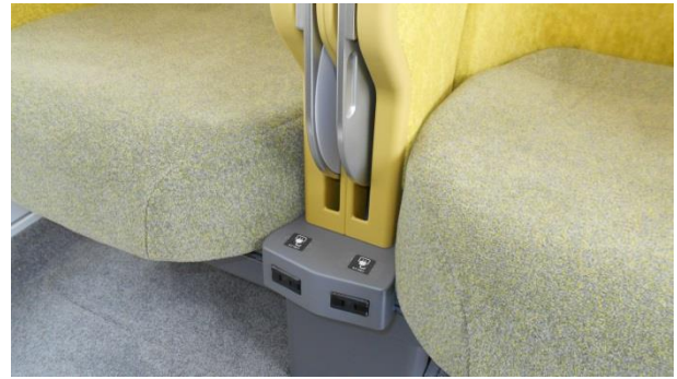
電源コンセント
