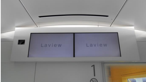
23 インチの大型車内ビジョン
